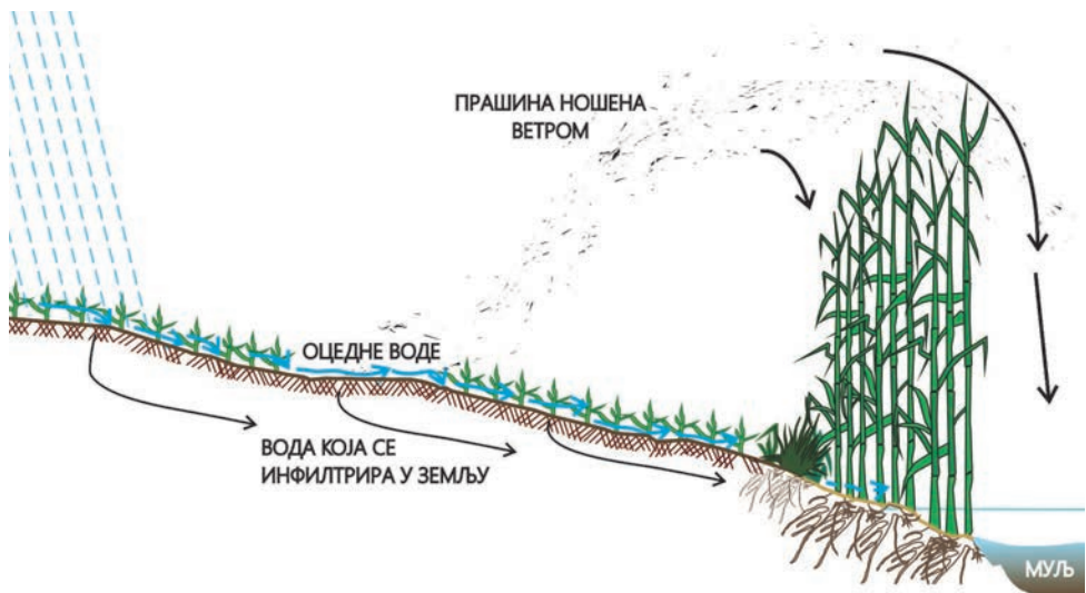
Слика 7. Шематски приказ дифузног загађења површинских вода
