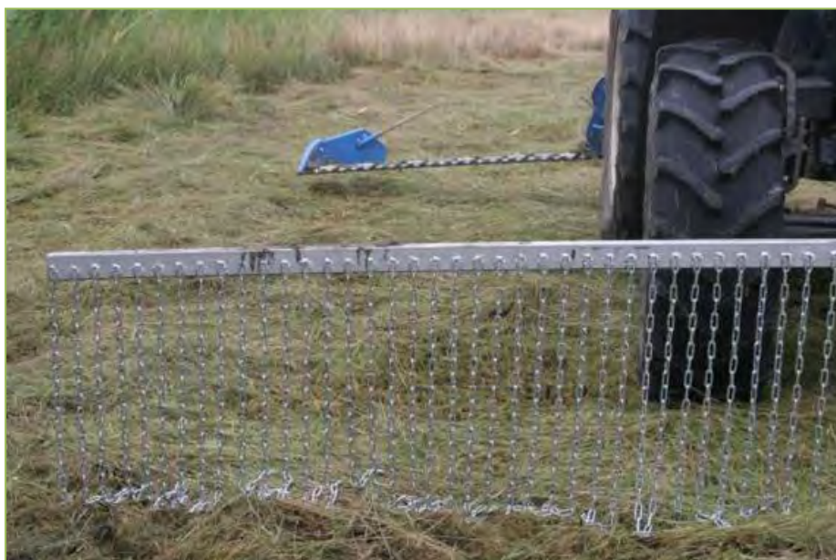
Слика 52: Сударање ланаца плашилице са стабљикама биљака подстиче крупније животиње за бекство, а ситне врсте падају на земљу, испод нивоа кошења. На тај начин се смањује број угинутих јединки при машинском кошењу.
